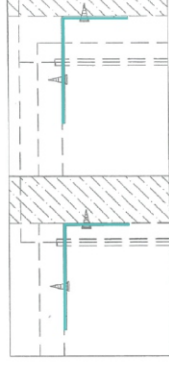
ติดตั้งบานพับ
