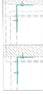
ติดตั้งบานพับ
